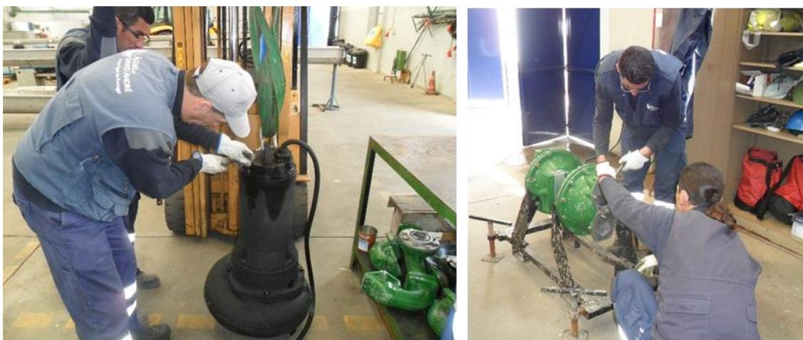
Figura 37 - Manutenção de bombas
