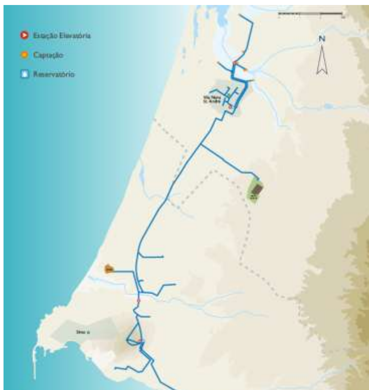
Figura 8 - Subsistema de Água Potável
