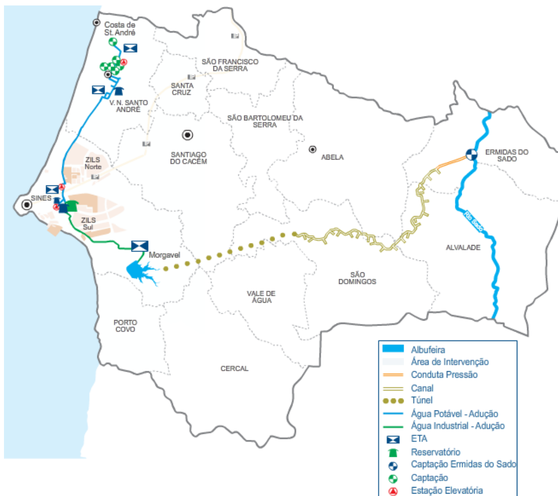
Figura 1. Esquema geral dos Subsistemas de Abastecimento de Água de Santo André
