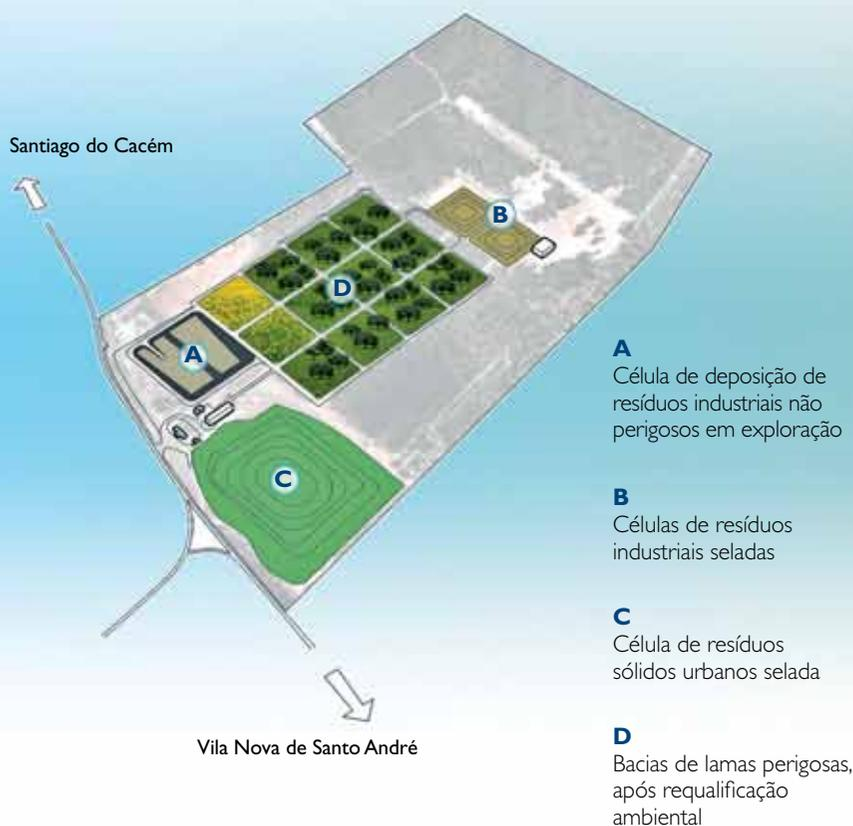
O RESIM dispõe de uma célula com um volume de encaixe total, à cota 65,50m, de 181.240m<sup>3</sup> e uma vida útil expectável de 16 a 23 anos (dependente dos quantitativos de resíduos a receber).
